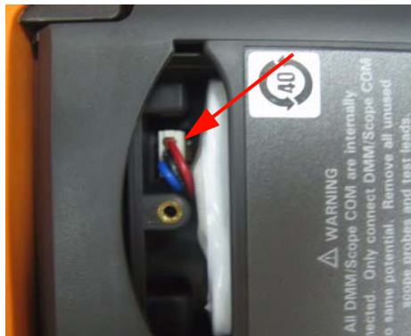
Abbildung 8-6 Entfernen Sie den 3-Draht-Stecker mit einer Pinzette.
