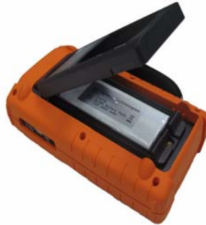
Abbildung 8-5 Entfernen Sie die Akkuabdeckung, ohne den Ständer zu entfernen
