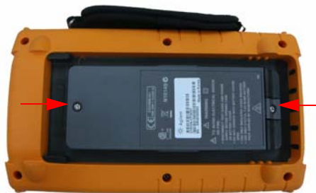
Abbildung 8-3 Entfernen Sie die Schraube der Akkuabdeckung
